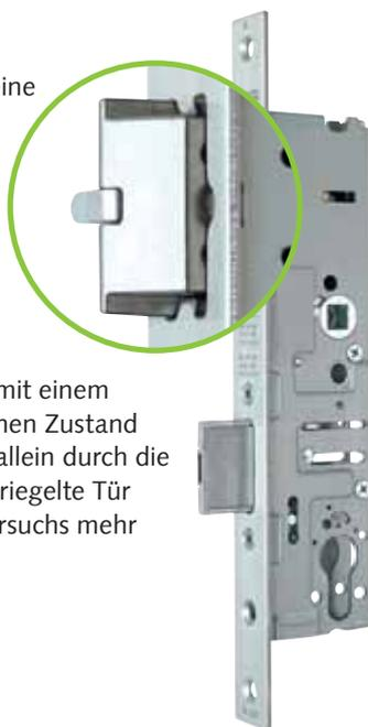
Das führt dazu, dass eine Tür mit einem Sv-Panikschloss im geschlossenen Zustand immer verriegelt ist und nicht allein durch die Falle zugehalten wird. Eine verriegelte Tür bietet im Fall eines Einbruchversuchs mehr Widerstand.
