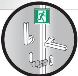
In Panikschlössern dürfen elektronische Knaufzylinder eingesetzt werden, wenn sie leichtgängig sind. Bitte immer mit WSS abklären, da bei einigen Schlössern nur Zylinder mit AP-Funktion zum Einsatz kommen dürfen.
