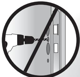
Das Türblatt darf im Schloßbereich nicht bei eingebautem Schloss durchbohrt werden.
