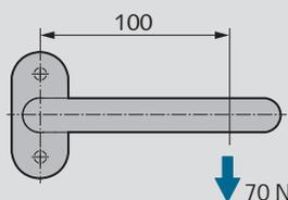
Die Türdrückerform muss so gewählt sein, dass keine vorstehenden Ecken und Kanten zu Verletzungen führen, Kantenradius mindestens 0,5mm. Das freie Ende des Drückers muss so ausgeführt sein, dass es zur Oberfläche des Türflügels zeigt, um das Risiko von Verletzungen zu vermeiden.
