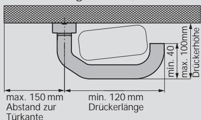
Zur Prüfung des Widerstandes gegen Missbrauch muss der Beschlag einer senkrechten zum Flügel angreifenden Kraft von 1.000N und einer parallel zum Türflügel angreifende Kraft von jeweils 500N standhalten.
