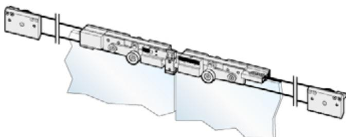
Der **Low-Energy-Antrieb** gewährt zusätzlichen Komfort und Sicherheit. Dieser Antrieb ermöglicht das automatische Öffnen und Schließen der Tür auf Knopfdruck. Die langsame Bewegung des Türelements gewährleistet das sichere Betreten und Verlassen des Raumes und ist somit optimal geeignet für das barrierefreie Wohnen.
