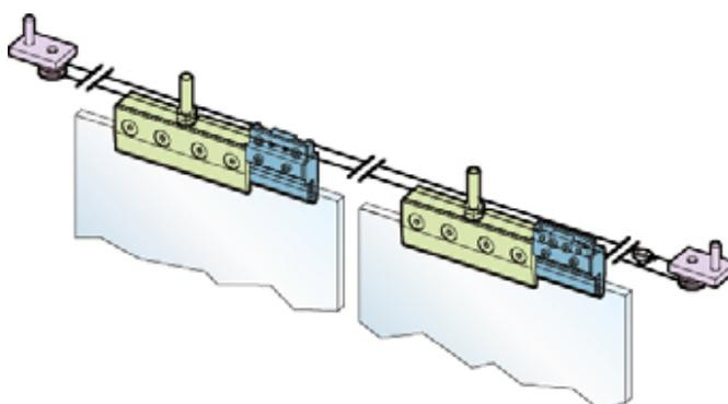
Mit dem **Dual-System** lassen sich zwei Flügel synchron bewegen.
