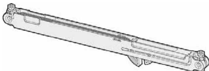
Mit dem **Dual-System** lassen sich mittels Umlenkrollen und Seilzug zwei Flügel synchron (gleichzeitiges Öffnen und Schließen von zwei Schiebeflügeln) bewegen.
