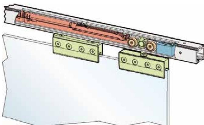
Durch den **SOFT-STOP** wird das Türelement sanft abgebremst und in die Endposition geführt.
