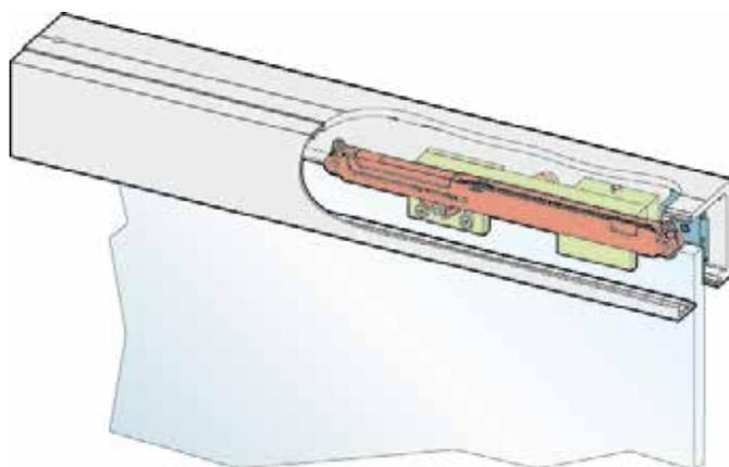
Durch den **SOFT-STOP** wird das Türelement sanft abgebremst und in die Endposition geführt.
