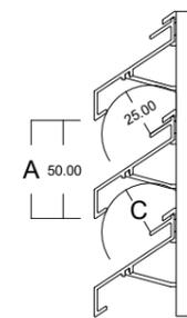
Der tatsächliche, physikalische freie Querschnitt/Nettodurchlass ergibt sich aus den Lamellenabständen C:A
